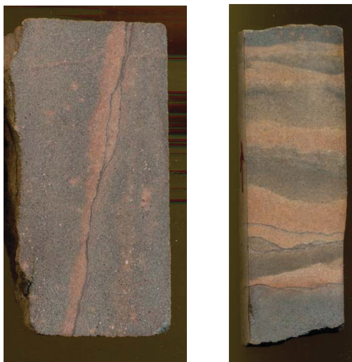
Abb. 8: Bohrkern- (oben) und Kalotten- (unten) -Aufnahmen mit bevorzugter Bleichung entlang von Klüften (links) und stratiform ausgebildeter Bleichung (rechts).
