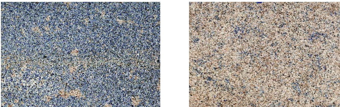
Abb. 16: Hier zeigen die Scan-Aufnahmen der Dünnschliffe ein poikiloblastisches Auftreten der Zemente. In der linken Aufnahme ist eine hohe Porosität mit nur geringen Zementanteilen, rechts das gegensätzliche Verhalten erkennbar. Eine mögliche Erklärung für dieses "fleckige" Auftreten der Zemente/Zementlösung können leichte Variationen der physiko-chemischen Bedingungen im Mikrometer-Bereich sein.
