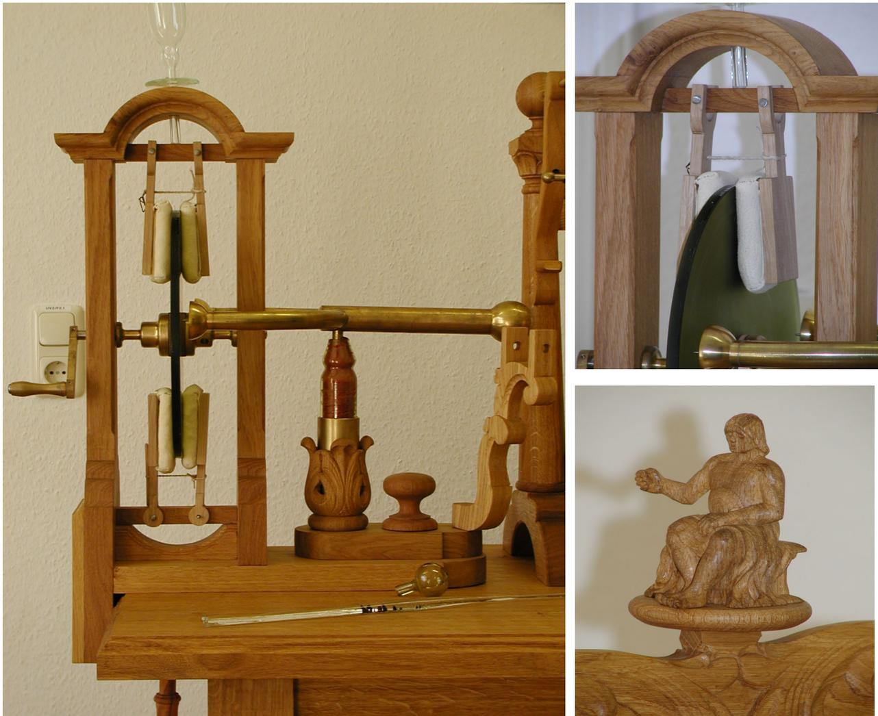
Abb. 3 Detailabbildungen der Replikation der Elektrisiermaschine von Schmidt (Seitenansicht, Reibkörper und Reibekissen, geschnitzte Zeusfigur)
