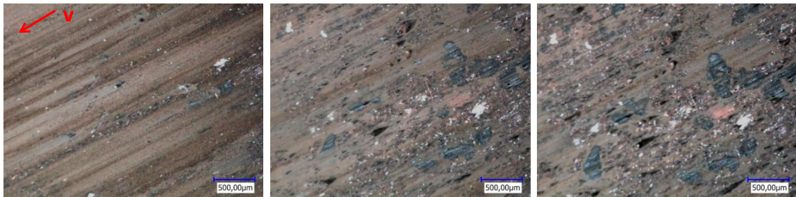
Abb. 7.49: Übergang zwischen druckloser Phase und der Bremsdruckapplikation (von links nach rechts, Zeitintervall zwischen den Aufnahmen t = 50 ms), MP 4, SN 2
