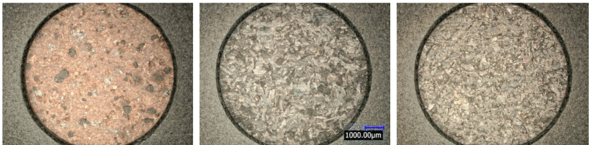
Abb. 13.84: Mikroskopaufnahmen 30x nach AK Master und Abblasen von NAO (links), ECE-kf (Mitte) und ECE-mk (rechts)
