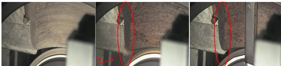
Abb. 13.38: trockene Reibzone vor der Benetzung (links) – Wasserkeilprägung während einer Stoppbremung (Mitte) und deren Abnahme zum Ende der Bremsung (rechts)
