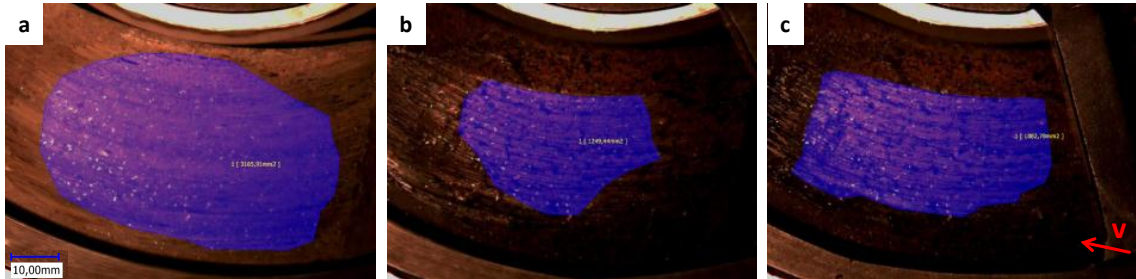
Abb. 7.74: Kontaktflächen während einer Stoppbremung (SN 2) bei 57 s (links), 63 s (Mitte), 71 s (rechts)
