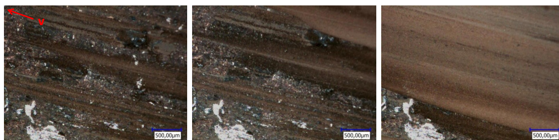
Abb. 13.31: einsetzende Überspülung von Kleinstpartikelströmen bei MP 6, nach 15 s (links), 21 s (Mitte) sowie 30 s (rechts) der Bremsung 2
