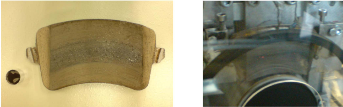
Abb. 8.14: NAO Belag nach Schleppprüfung (links), Hot Spot Bildung während einer Schleppbremsung (rechts)
