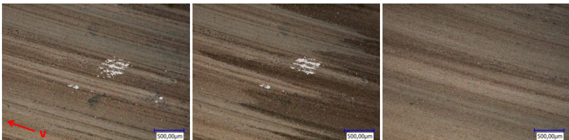
Abb. 7.54: gesteigerte Überspülung von Kleinstpartikeln bei MP 9 zu Beginn (links), nach 2 s (Mitte) und nach 10 s (rechts) der Bremsung 2
