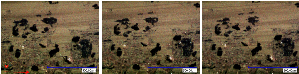
Abb. 13.23: lokale Patchdynamik während einer Stopbremsung, 100-fache Vergrößerung, bei 0,4 s (links), 4,7 s (Mitte) und 5,3 s (rechts) der Bremsung, SGG_e
