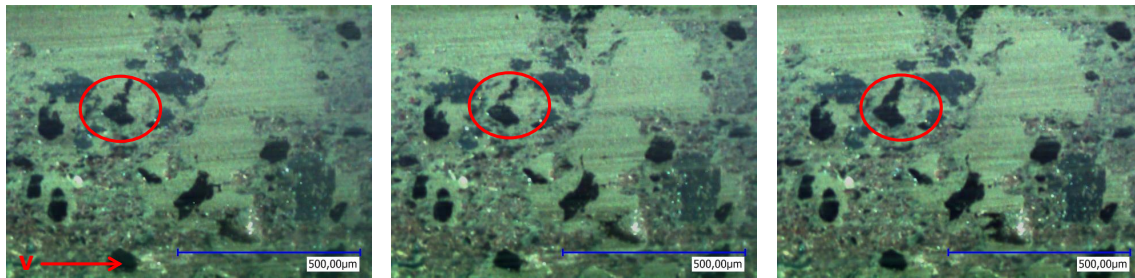
Abb. 7.44: lokale Patchdynamik während einer Schlepptbremsung, 100-fache Vergrößerung, bei 1,75 s (links), 57,5 s (Mitte) und 118,7 s (rechts) der Bremsung, SGG e
