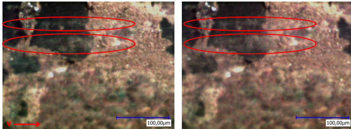
Abb. 7.46: lokale Partikeldynamik während einer Schleppbremsung, 300-fache Vergrößerung, bei 24,3 s (links) und 41,3 s (rechts) der Bremsung, SGG v
