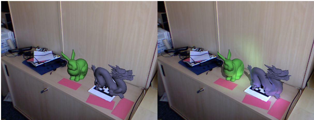
Abbildung 7.13: Vergleich AR-Anwendung ohne globale Beleuchtungseffekte (links) und mit globalen Beleuchtungseffekten durch das LightSkin-Verfahren (rechts).
