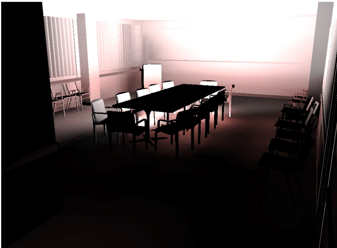
Abbildung 8.14: Indirekte Reflexionen mit weichen Schatten. Das obere Bild zeigt die Kombination von direkter und indirekter Beleuchtung und das untere nur die indirekte Beleuchtung. Die Szene besteht aus 2.014 Caches.
