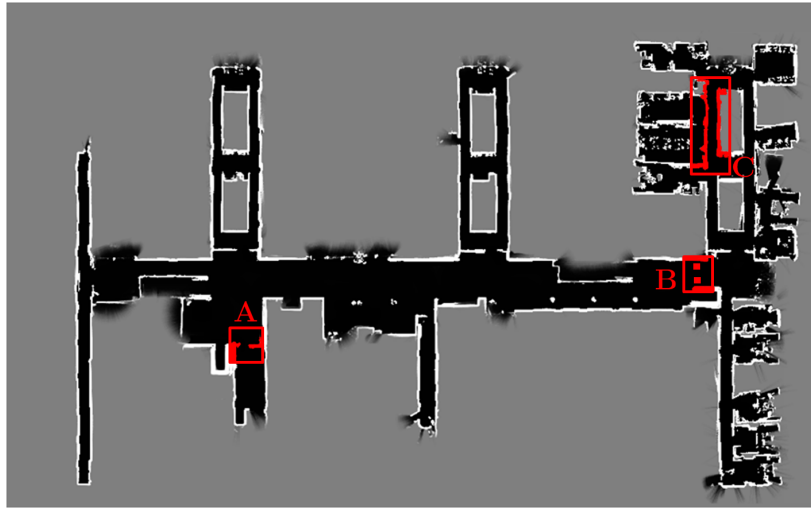
Abbildung 5.2: Gebäudegrundriss der Aufnahmeumgebung. Die rot markierten Bereiche sind die Engstellen der beschriebenen Aufnahmen. Die Engstelle A und C resultieren aus der Gebäudestruktur. Die Engstelle B wurde durch zwei künstliche Hindernisse erzeugt.
