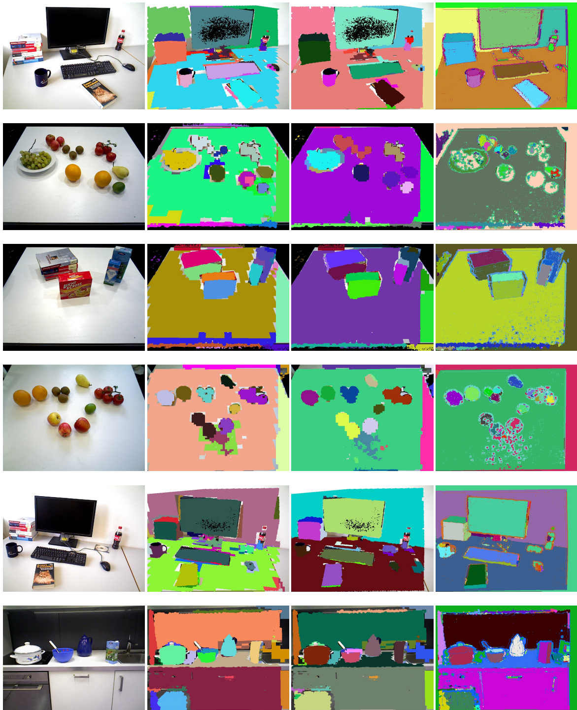
Abbildung A.3: Ergebnisse der Segmentierung. Von links: Originalbild, Tiefen- und Farbsegmentierung, Tiefen- und Textursegmentierung, Tiefensegmentierung.
