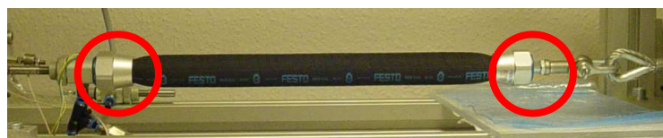
Abbildung 6. 13: Der pneumatische Muskel im Prüfstand P.E.X.T.E.R.
