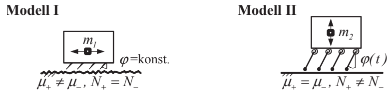
Abb. 4.2: Konfigurationen des Mehrkörpermodells aus Abb. 4.1 für die Simulationen
