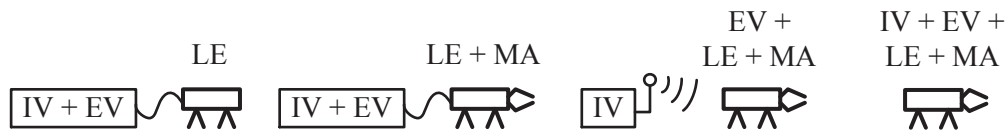
Abb. 1.2: Klassifikation mobiler Roboter in Abhängigkeit ihrer Funktionsintegration nach [Ebe02] (IV - Informationsverarbeitung, Steuerungseinheit; EV - Energieversorgung; LE - Lokomotionseinheit; MA - Manipulatoren)
