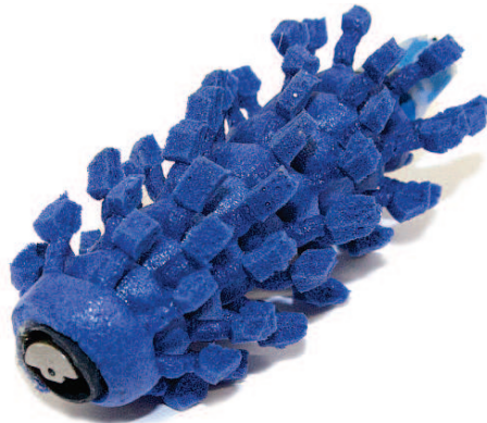
Abb. 4.9: Prototyp eines vibrationsbasierten Roboters mit Borsten für die unidirektionale Lokomotion in Röhren mit D = 25 mm [Bec13a]
