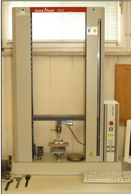
Abb. 19: Spannvorrichtung für den Dreipunkt-Biegetest in der Universalprüfmaschine
