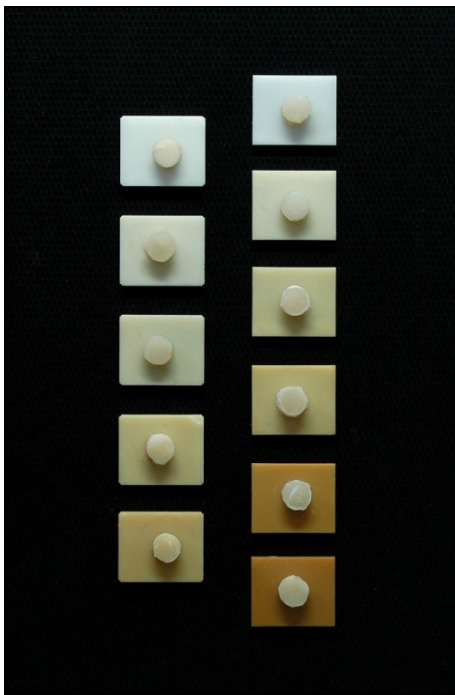
Abb. 23: Verbundprüfkörper Variolink® II, links: Vita In-Ceram® YZ, rechts: Sirona inCoris ZI
