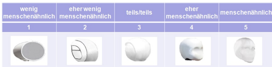
Abbildung 5.11. Getestete Roboterköpfe (Beispiel für die Gestaltung der Robotermerkmale und deren Ausprägung auf der Skala zur Messung der wahrgenommenen Menschenähnlichkeit).
