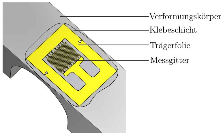
Abbildung 2.1: Verformungskörper mit aufgeklebtem Dehnungsmessstreifen.
