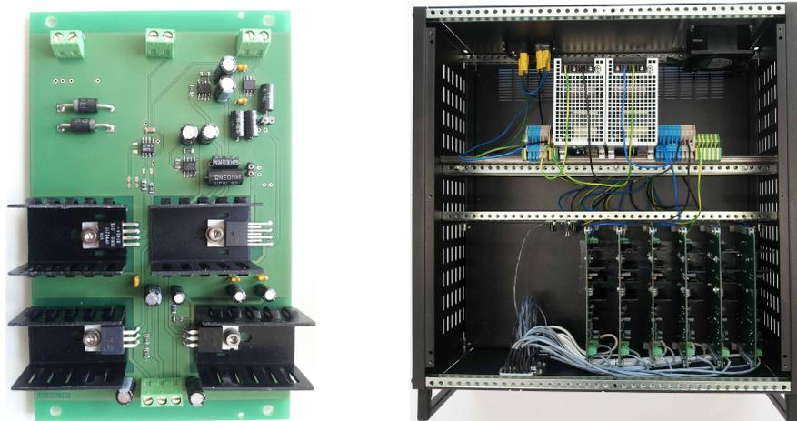
Abbildung 5.3: Leiterplatte einer Stromtreiberschaltung (links) und 6-Kanal Stromtreibereinheit im 19" Gehäuse (rechts).
