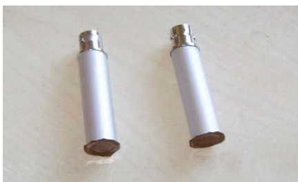
Abb. 7-6 PCD Wandler nach Fertigstellung.
