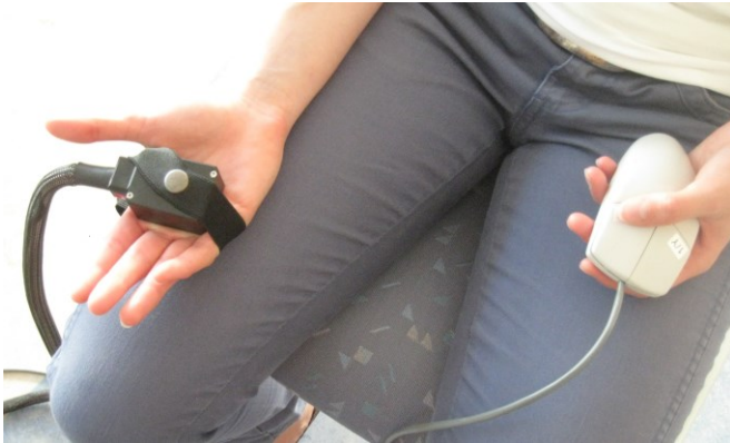
Abbildung 9. Thermostimulation an der Handinnenseite und response-unit (Maus). (Quelle: Eigene Darstellung)
