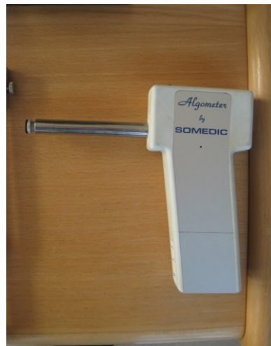
Abbildung 19. a,b Das Druckalgotometer zur Messung der Druckschmerzschwelle, welche stets über Muskulatur bestimmt wird. (Quelle: Eigene Darstellung)
