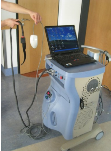
Abbildung 8. Thermostimulator mit Thermode und response-unit sowie PC zur Steuerung des Stimulationsprogramms (Quelle: Eigene Darstellung).
