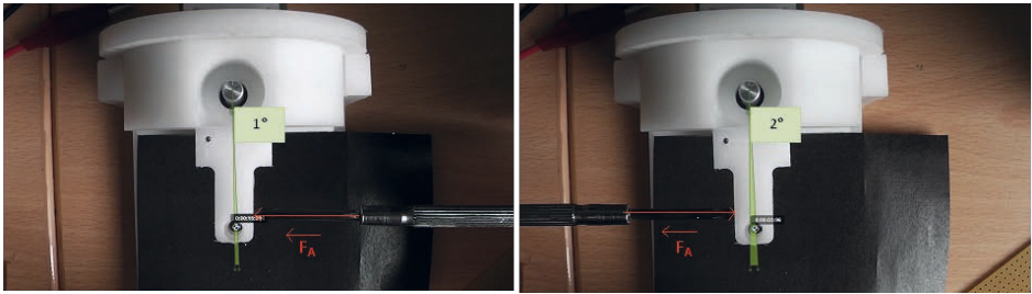
Abbildung A - 23: Bestimmung des Spiels in Richtung der positiven und negativen Abszisse
