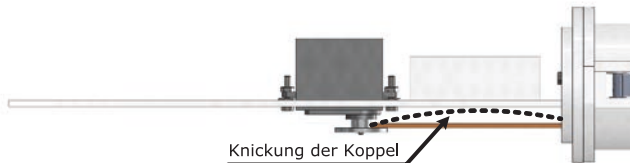
Abbildung 102: Darstellung der infolge der Oszillation einer Knickung unterworfenen Koppel innerhalb des Antriebsstrangs
