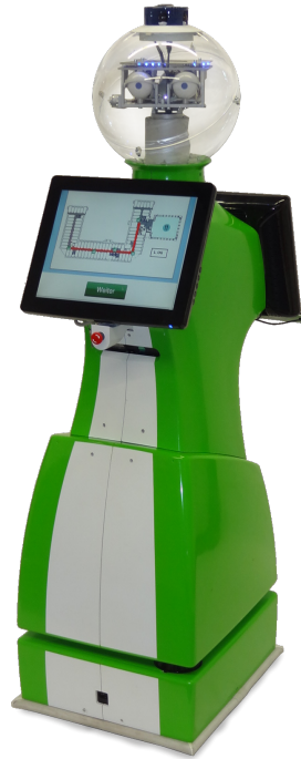
Abbildung 1.2: Roboter RO-REAS, Schlaganfallrehabilitation und Orientierungstraining
