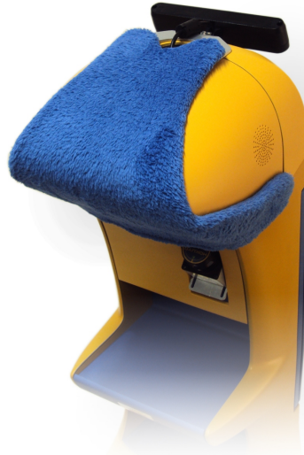
Abbildung 8.1: Blauer Streichelfellsensor auf dem Hinterkopf des Serviceroboters (Ansicht von hinten)
