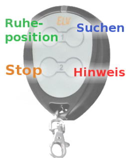
Abbildung A 2.1: Funkfernbedienung zum Rufen des Roboters
