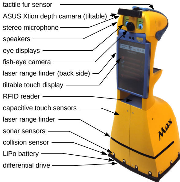
Abbildung 1.3: Roboter Max mit seinen Sensoren und Aktoren
