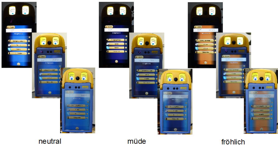
Abbildung 8.12: Anpassung der Bildschirmhintergrundfarbe an die simulierte Emotion und die vorliegende Umgebungshelligkeit
