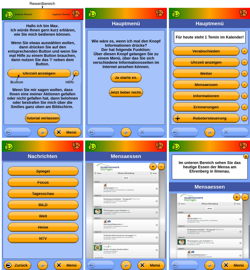
Abbildung 7.3: Verschiedene Bildschirmseiten der Office Mate Applikation. Im oberen Bereich ist die Feedbackleiste sichtbar, über welche der Nutzer die Aktionen des Systems belohnen oder bestrafen kann. Die beiden letzten Seiten zeigen die Mensaspeisepläne einmal ohne und einmal mit eingebledetem Hilfetext. Das Schließfeld des Hilfetextes wird als negatives Feedback gewertet. Bilder übernommen aus [Sprenger, 2013]
