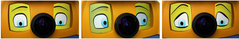
Abbildung 8.14: Beispielhafte Augenbilder: links - neutrale Mimik, Mitte - verfolgen eines Nutzers mit den Augen, rechts - trauriger Ausdruck.
