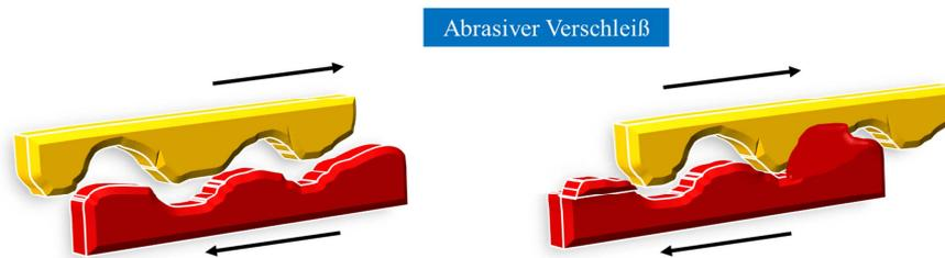
**Abbildung 10: Schematische Darstellung von abrasivem Verschleiß (21), (22)**
