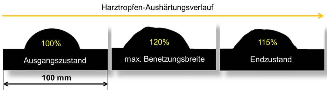
**Abbildung 34: Schattenbilder des Harztropfens im Erhitzungsmikroskop zur Bewertung des Benetzungsrückgangs an der Grenzfläche Harztropfen/Trennschicht**
