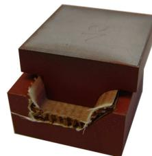
**Abbildung 25: Ausgehärtetes Bauteil vor Entnahme aus mit PEEK/PFA beschichtetem Formwerkzeug**
