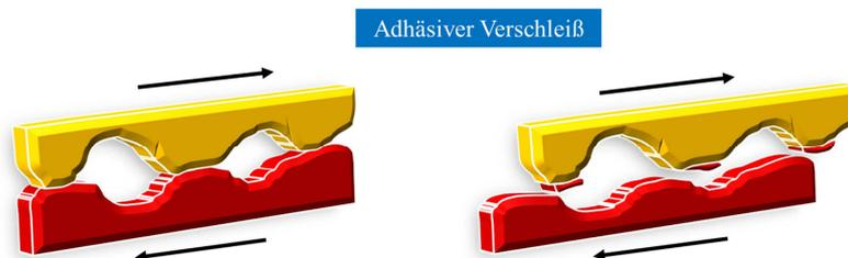
**Abbildung 9: Schematische Darstellung von adhäsivem Verschleiß (21), (22)**
