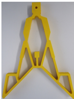
Abb. 8: Nachgiebiger Greifer ohne Sensorelemente aus [8]
