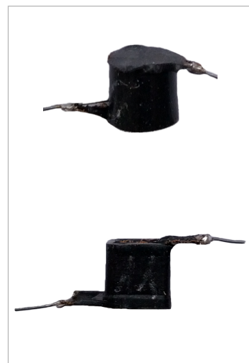
(b) Zylindrische und kubische Sensorelemente
