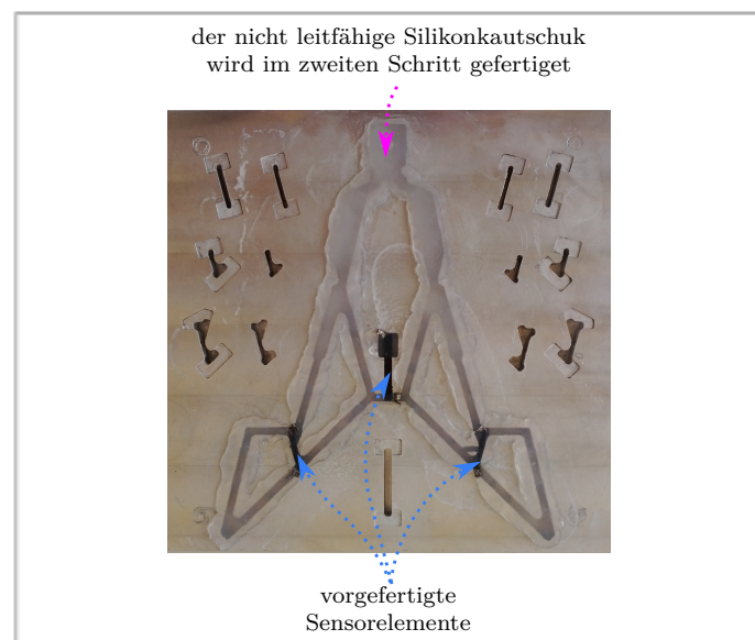
(b) Das mit dem nicht leitfähigen Silikonkautschuk und den vorgefertigten Sensorelementen gefüllte Presswerkzeug
