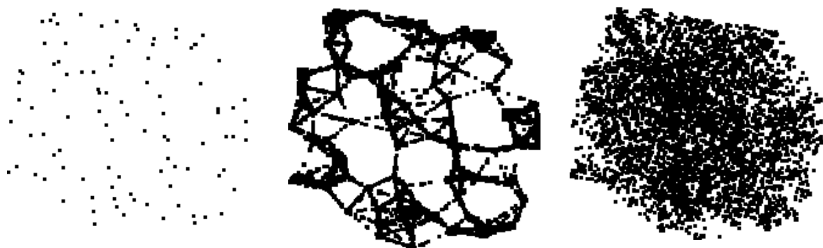
Abbildung 4-3: Anwendung des SMOTE-Algorithmus: Punktwolke ohne GV (links), mit GV durch SMOTE bei 5 nächsten Nachbarn (Mitte) und bei 99 nächsten Nachbarn (rechts)[TSW14]
