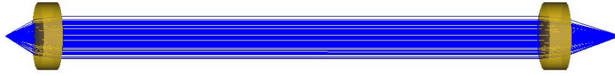
Abbildung 6.3: Design der asphärischen Linzen aus ZnSe zum Kollimieren und Einkoppeln der Laserstrahlung in eine Single-Mode Faser.
