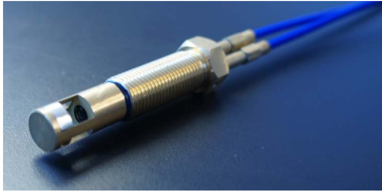
Abbildung 6.13: Einsatzfähiger Prototyp des Single Port Sensorkopfs. Unten beträgt der Durchmesser 10 mm und oben entspricht er einem M12-Gewinde. Die Gesamtlänge ohne Fasern beträgt 55 mm
