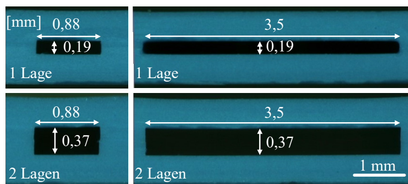
Abbildung 6.1: Verschiedene realisierte Kanalgometrien mit Carbonfolie in einer bzw. zwei Lagen.
