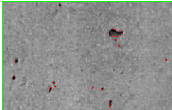
Abb. 4: Lunkerflächen, bereits als Ellipsen approximiert
