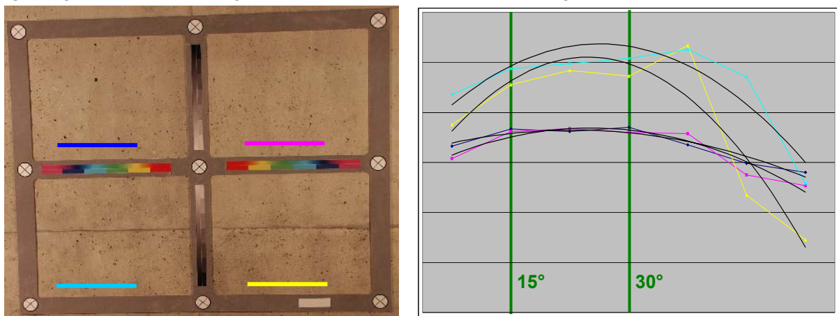
Abb. 9: Einfluss unterschiedlicher Beleuchtungswinkel, links Auswertebildbereich, rechts Messwertverläufe mit überlagerten Trendlinien (Polynome 2. Grades), der jeweils für die Quadranten stabile Bereich zwischen 15° und 30° ist gekennzeichnet, gleichfalls die Quadrantenzuordnung mit farbigen Linien, die unteren beiden Quadranten enthalten eine störende Fuge, nicht herauseditiert.
