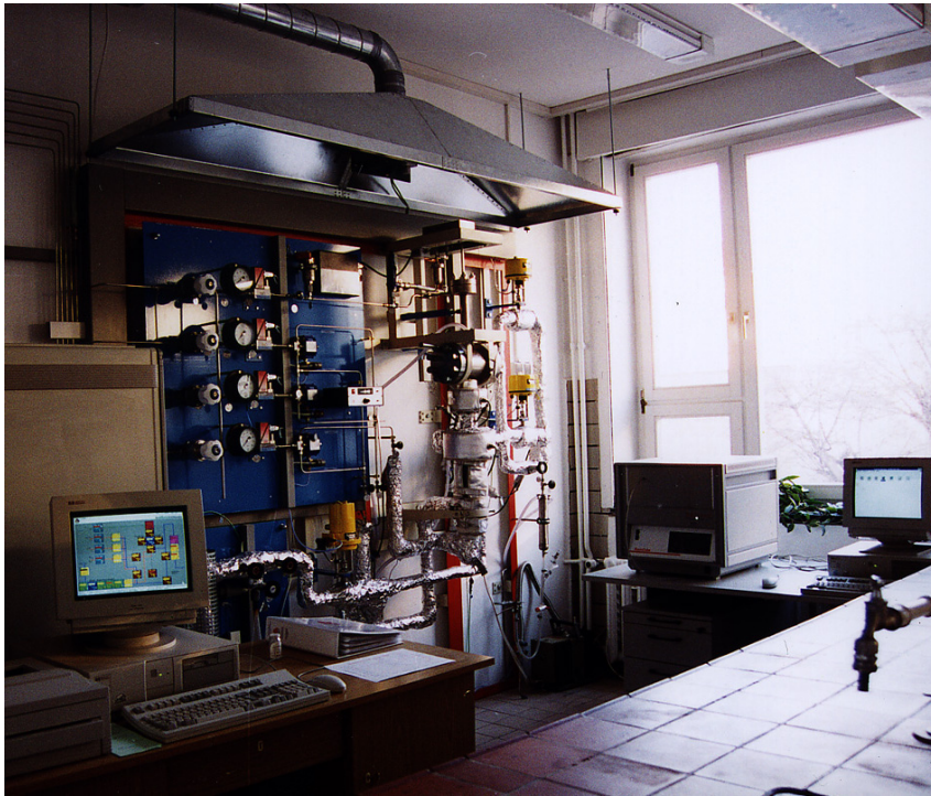
Abbildung 4-7: Foto der Thermowaage an der Bauhaus-Universität in Weimar
