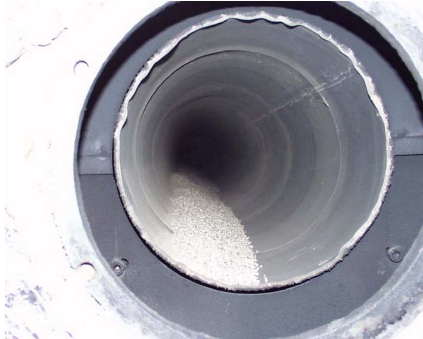
Abbildung 5-5: Versuch mit Sand, mittlerer Füllgrad ca. 5 %.
