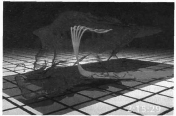
61 Intelligente Gebäude werden heute mit Hilfe von Simulationsprogrammen entworfen (hier eine Strömungssimulation).
