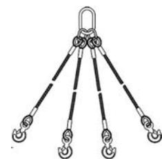
Abb. 4.22 Viersträngiges Anschlagseil (DIN 13 414-2)
