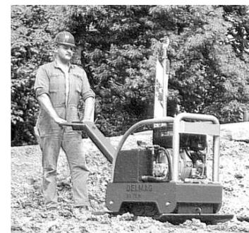
Abb. 2.37 vollhydraulische reversierbare Rüttelplatte (DELMAG)
