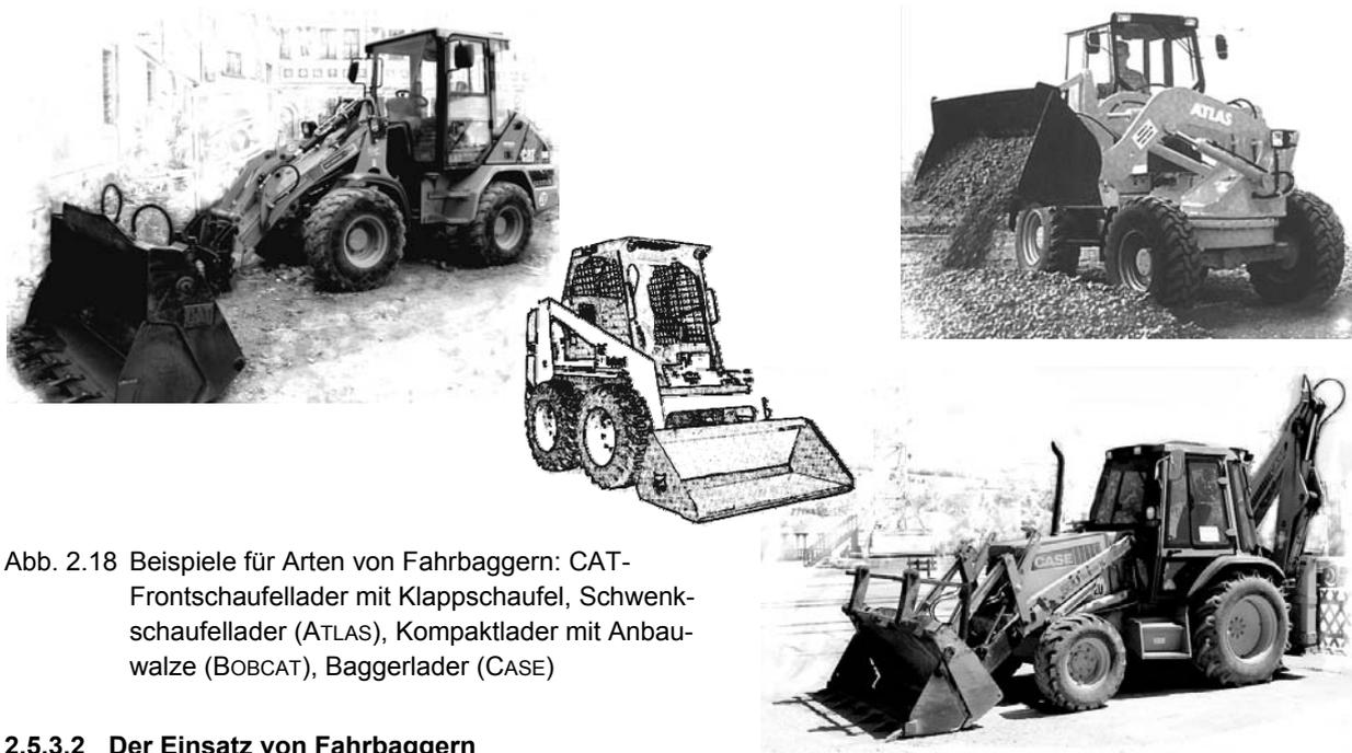
Abb. 2.18 Beispiele für Arten von Fahrbaggern: CAT-Frontschaufellader mit Klappschaufel, Schwenkschaufellader (ATLAS), Kompaktlader mit Anbauwalze (BOBCAT), Baggerlader (CASE)
