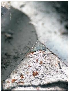
Bild A.121. Geometrie stehenbleibender Riss, 90° BV (18CrNiMo7-6), Probe 209, Durchläufer  $\Delta p=2950$  bar, [71, Bild A.65]
