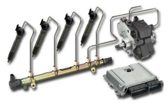
Bild 2.1. Common Rail System (Volkswagen AG)
