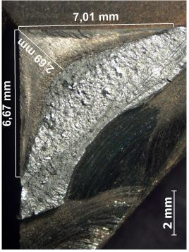
Bild A.113. Geometrie stehenbleibender Riss, 90° BV (42CrMo4), Probe 4 - Ecke 1, Durchläufer  $\Delta p=3000$  bar, Tabelle A.24
