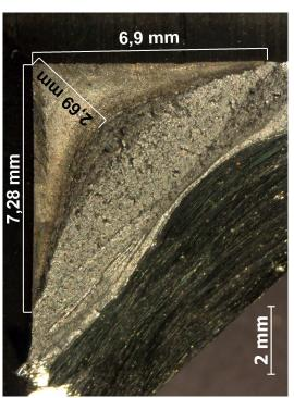
Bild A.114. Geometrie stehenbleibender Riss, 90° BV (42CrMo4), Probe 4 - Ecke 2, Durchläufer  $\Delta p=3000$  bar, Tabelle A.24
