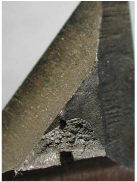
Bild A.108. Rissstopp an  $45^{\circ}$  Bohrungsverschneidung, h/d=15/5, aus [107, Bild 5.14] und [276, Bild 2]
