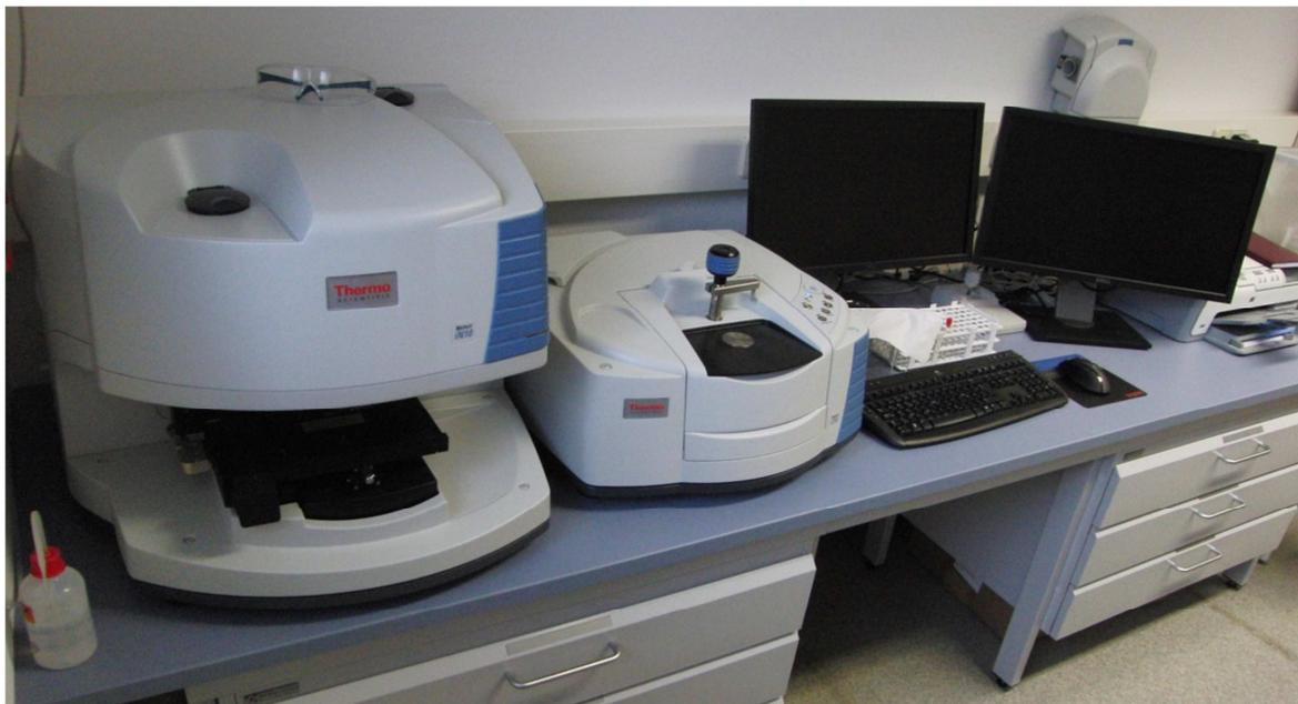
Abbildung 70: FT-IR Mikroskop Nicolet iN10 und dem externen ATR-Modul Nicolet iS10
