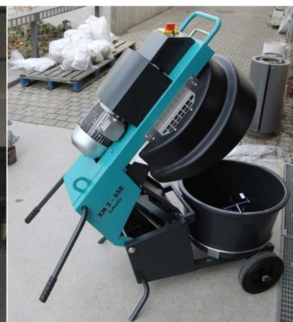
Abbildung 74: Fahrbarer Mischer Collomix XM-2
