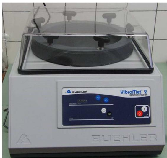
Abbildung 71: VibroMet2, Vibrationspoliergerät
