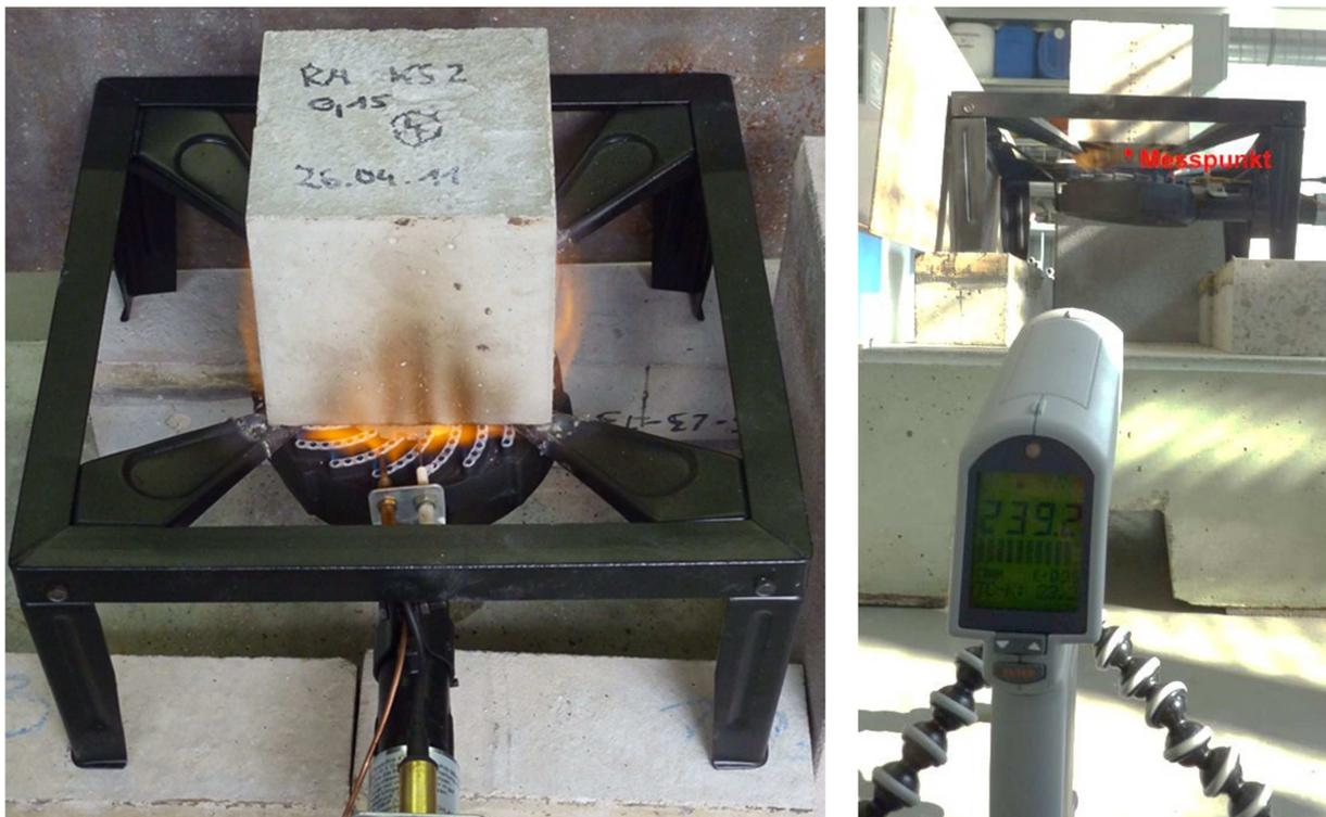
Abbildung 48: Versuchsaufbau mit Hockerkocher und Temperaturmessung
