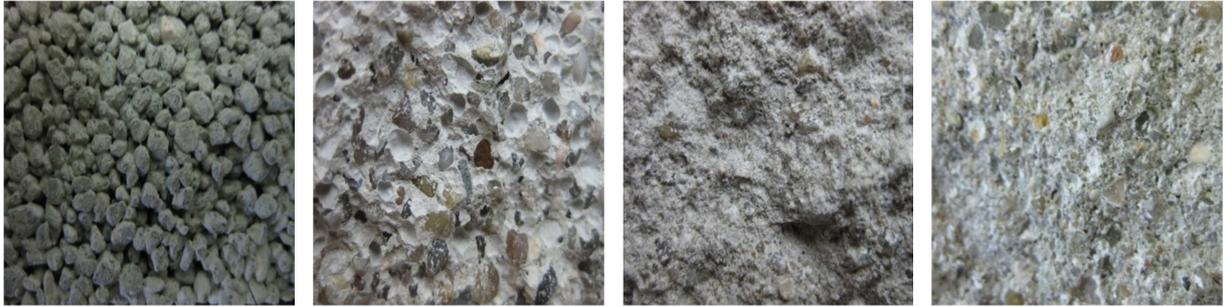
Abbildung 42: CC-Gefüge v. l. n. r.: haufwerksporige Ausfallkörnung, haufwerksporige stetige Sieblinie, hoch gefüllte Ausfallkörnung, hoch gefüllte stetige Sieblinie
