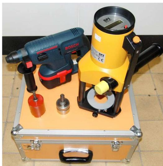
Abbildung 72: Haftzugprüfgerät mit Prüfstempel, Bohrkronen und Akku-Bohrhammer
