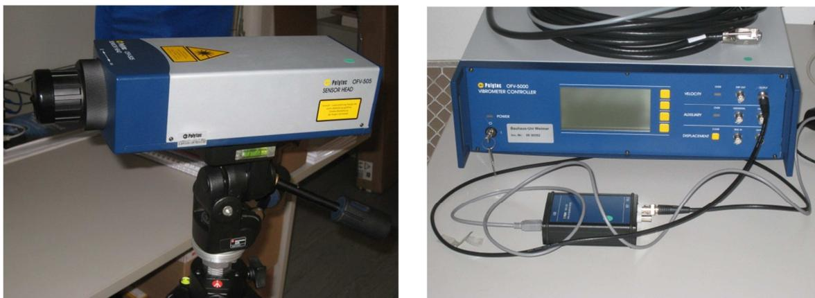
Abbildung 78: Vibrometerkopf OFV 505 mit Stativ (li.) und Controller OFV 5000 (re.)
