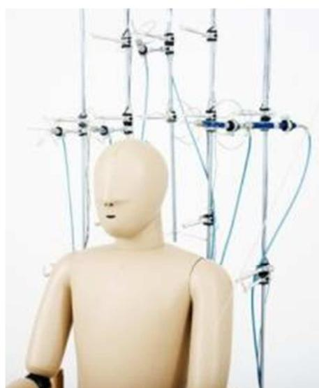
Abbildung 16: Sensorik bei der Untersuchung des Mikroklimas
