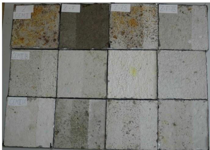
**Abbildung 47: Einwirkung von Salzsäure in unterschiedlicher Konzentration auf verschiedene Zemente**
