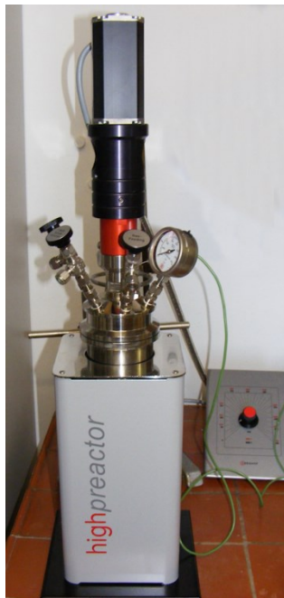
Abbildung 10: Autoklav BR 700 mit Rührfunktion.
