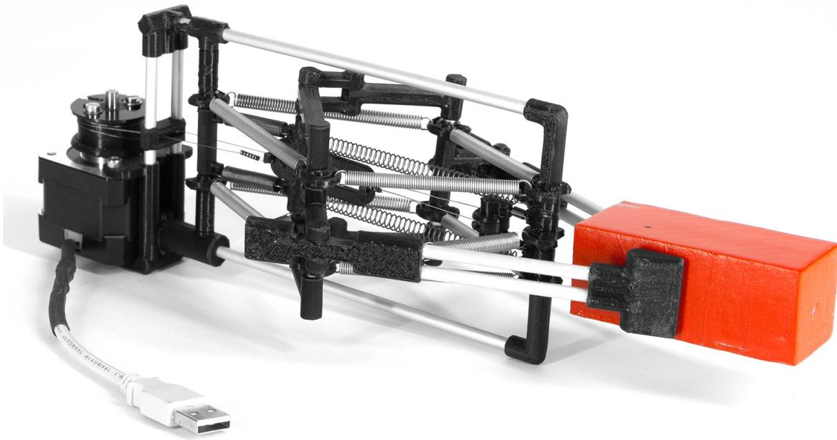
Abbildung 5.24: Tensegrity-Greifer mit rotatorischem Antrieb.
