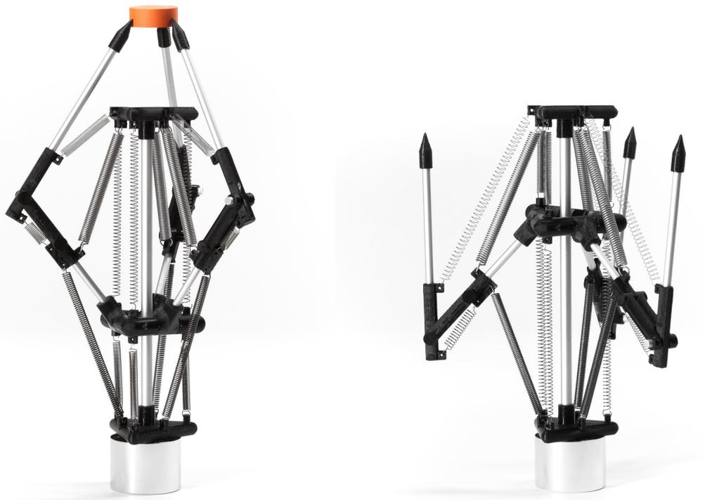
Abbildung 5.32: Funktionsmuster des 3D-Tensegrity-Greifers.
