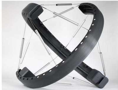
(b) Kugelförmiger mobiler Roboter, Lokomotion durch Änderung des Schwerpunktes, [Böh16b]. © [2016] IEEE
