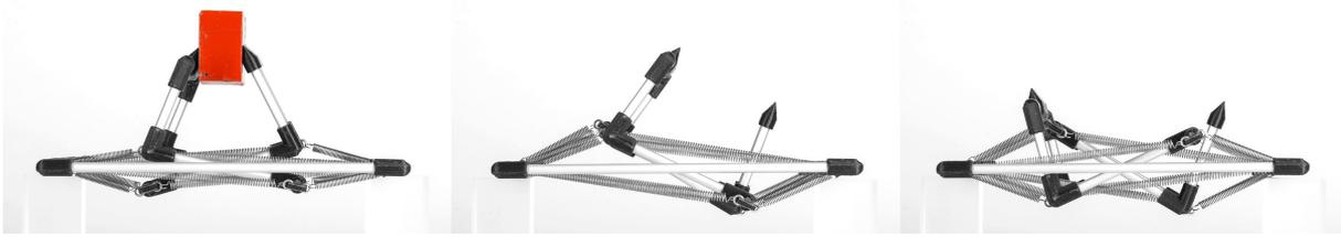
Abbildung 5.37: Tensegrity-Greifer der Klasse 1 - Variante C. Von links nach rechts: geschlossen, einseitig geöffnet, geöffnet.
