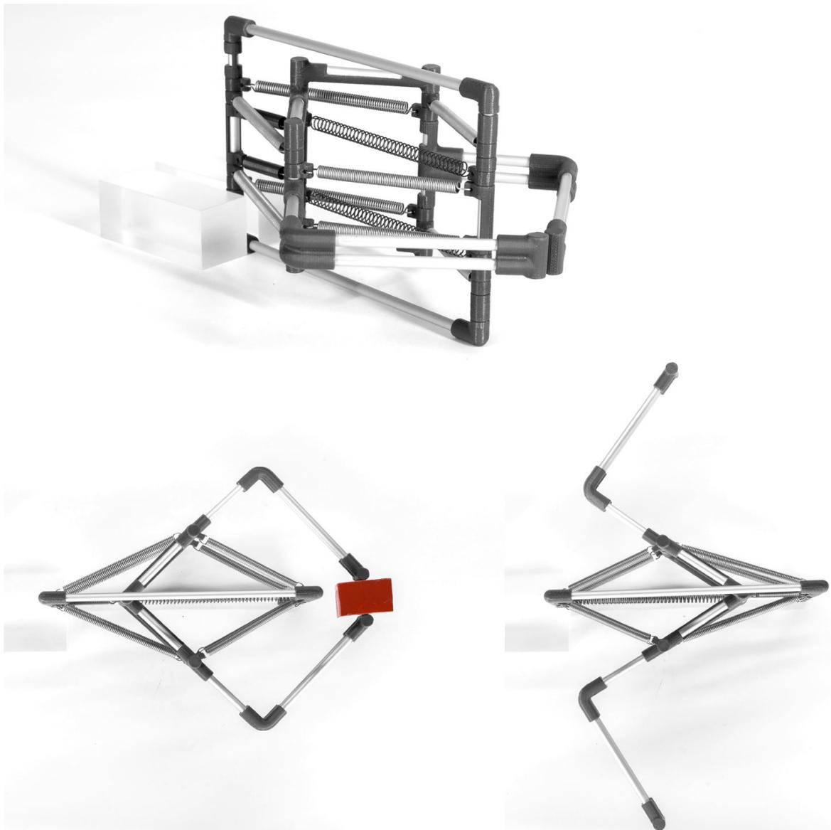
Abbildung C.1: Erstes Funktionsmuster des Tensegrity-Greifers, mit steifen Greifarmen. Breite: 9.5 cm, Länge: 14 cm, Abstand zwischen Greiferspitzen im geöffneten Zustand: 28 cm.
