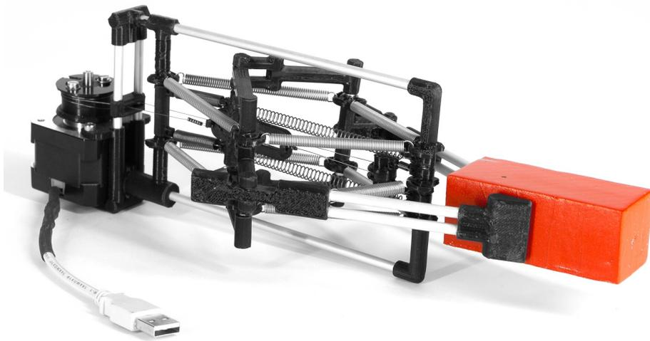
Abbildung C.3: Drittes Funktionsmuster des Greifers, mit gelenkigen Greifarman. Breite: 8 cm, Länge: 14 cm, Abstand zwischen Greiferspitzen im geöffneten Zustand: 9 cm.
