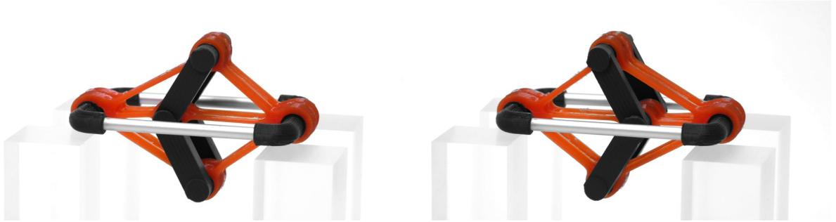
Abbildung 5.28: Verkleinerte Version der dem Tensegrity-Greifer zugrundeliegenden Tensegrity-Struktur (Topologie C) in Gleichgewichtskonfiguration I und II.
