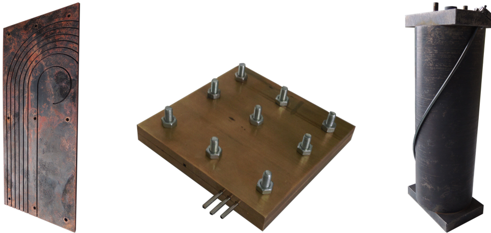
(a) Einzelne Kupferplatte mit Nutenbahnen für eben vorgekrümmte Röhren. (b) Verschraubte Messingplatten mit drei eingelegten Röhren. (c) Vorrichtung zur Einprägung einer helixförmigen Vorkrümmung.
