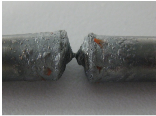
(b) Durch den Lichtbogen verschweißte Elektroden nach 20 Sekunden Brenndauer mit 11 A
