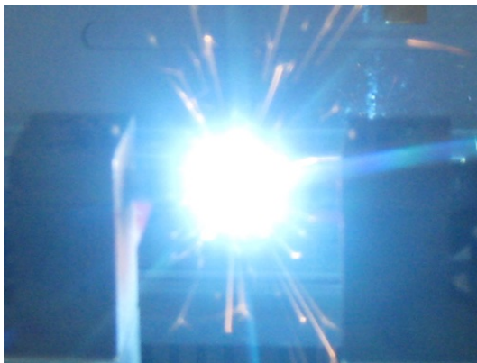
(a) Lichtbogen von 2 mm Länge bei 8 A
