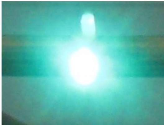
(a) Brennender Lichtbogen mit 2 mm Länge bei 8 A
