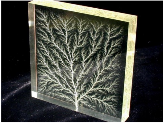
Abbildung 2.5: Lichtenberg Figur in Form einer Hochspannungsentladung in einem Plexiglasblock als Beispiel für ein selbstähnliches Gebilde mit fraktalem Charakter (Quelle: wikipedia.org [145])
