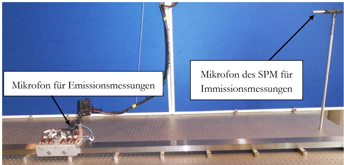
Abbildung 6.1: Experimenteller Aufbau für Schalldruckpegelmessungen mit Mikrofon am Läufer für Emissions- und einem Mikrofon des SPM an einem festen Ort für Immissionsmessungen
