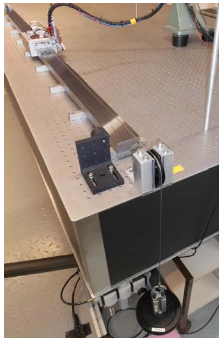
Abbildung 4.13: Experimenteller Aufbau zum Erzeugen verschiedener Lastkräfte
