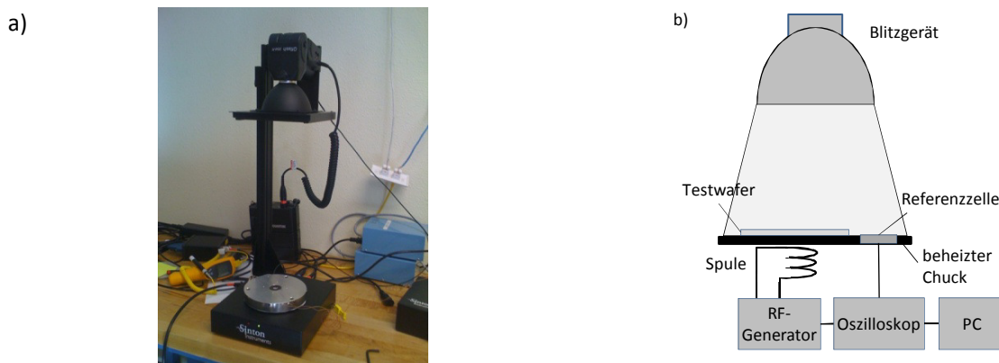
Abb. 3.7: a) Apparativer Aufbau der WCT 120 Anlage b) Schematische Darstellung des WCT 120. Bei der WCT 120 Anlage liegt der Wafer auf einem beheizbaren Probenhalter mit integrierter Spule auf. Der Wafer wird von oben mit infrarotem Licht beleuchtet. Die Referenzsolarzelle befindet sich neben dem beheizbaren Probenhalter.
