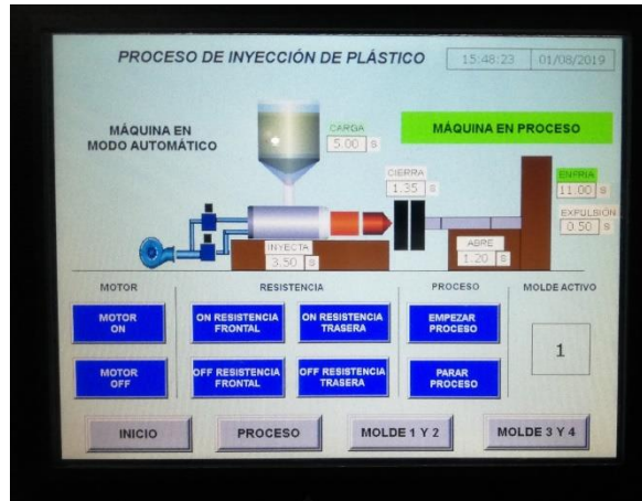
Figura 3. 27 Funcionamiento del HMI
