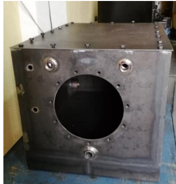
Figura 3. 5 Adecuaciones del Tanque
