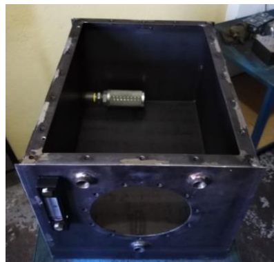
Figura 3. 6 Filtro de Succión y su ubicación
