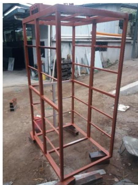
Fotografía 3. Construcción de cabina en taller
