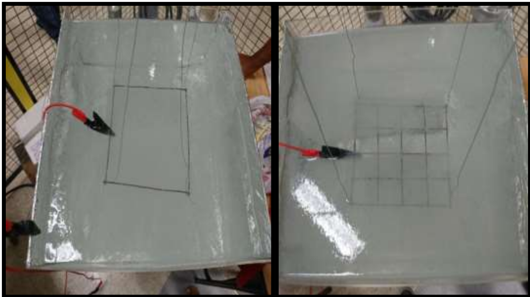
FIGURA 29: REACCIÓN QUÍMICA DE MALLA CUADRADA Y REJILLA CON ELECTROLITO
