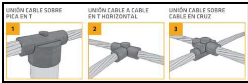
FIGURA 3. TIPOS DE UNIONES CON SOLDADURA EXOTERMICA. [7]
