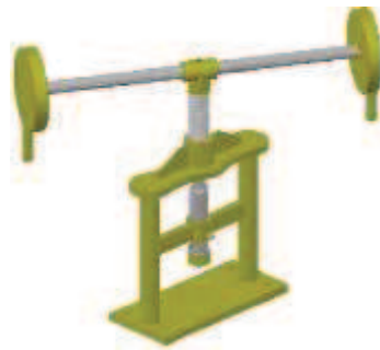
Figura 10 Troqueladora tipo prensa de balancín a tornillo
