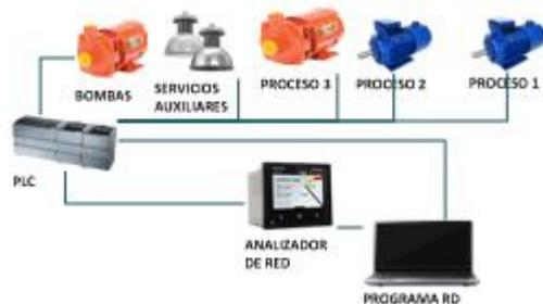
Figura 3. Arquitectura del sistema de respuesta a la demanda eléctrica.
