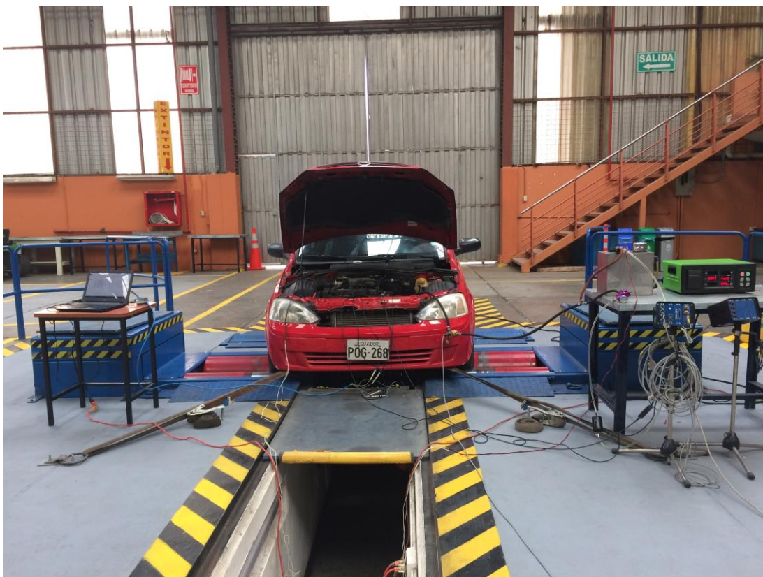
Figura 6.58. Funcionamiento del motor con las fallas para comprobar programa desarrollado.
