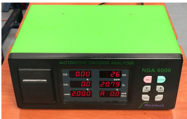
Figura 6.3. Analizador de gases.
