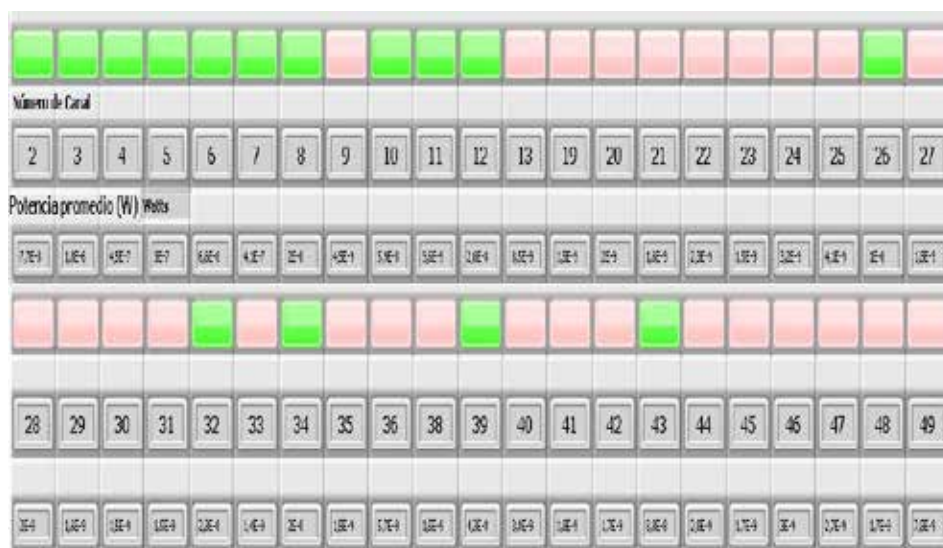
Figura 9. Indicador de canales libres y ocupados para la zona de Ambato Tennis Club, Parroquia Ficoa
