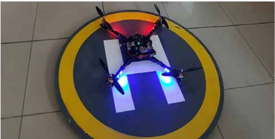
Figura 3. Prototipo de cuadricóptero construido
