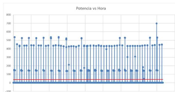
**Figura 3** Consumo del dispensador de agua en 24 horas.
