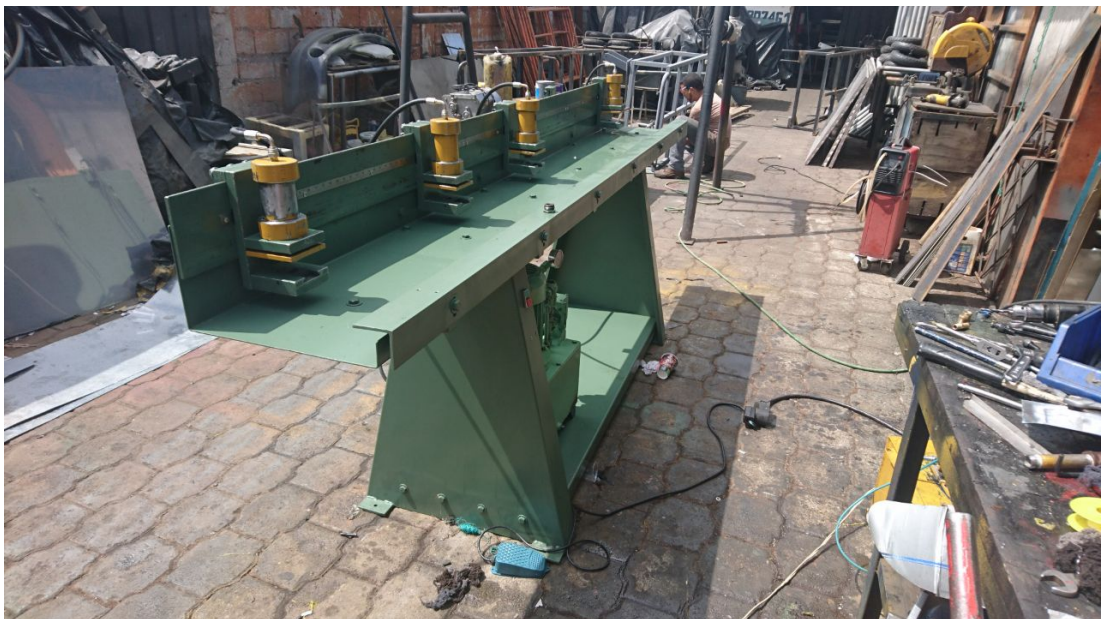
Montaje de los cilindros hidráulicos.
