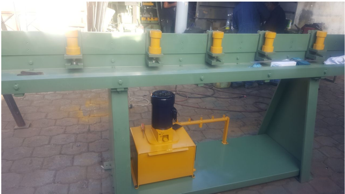
Máquina muescadora terminada.
