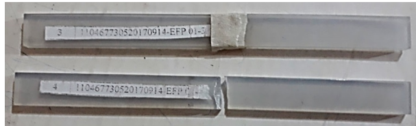
Figura 6. Probetas ensayadas del material matriz.
