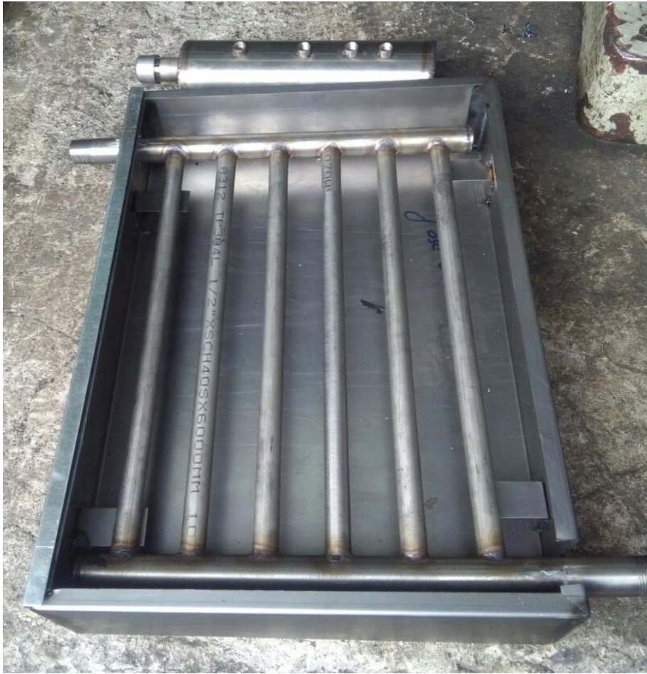
Construcción del colector tipo parrilla.
