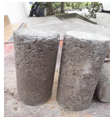
Figura 2. Muestras de hormigón sometidas a 15 ciclos de inmersión en solución de sulfato y secado
