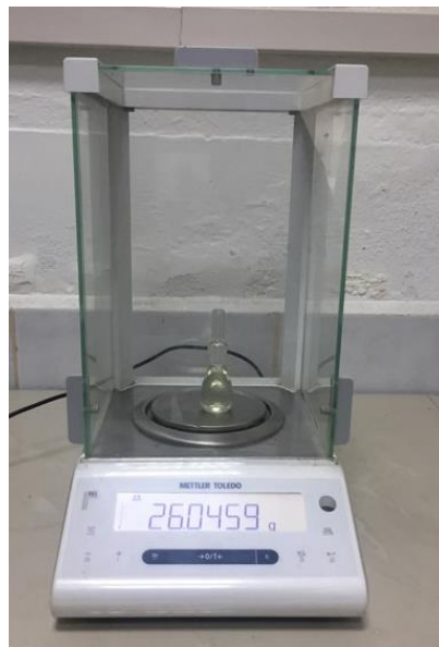
Figura 6: Peso de la pipeta volumétrica con gasolina súper. Fuente: Autores
