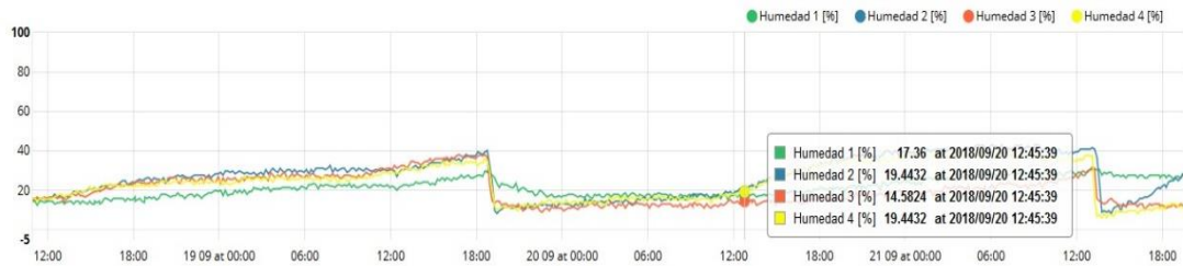
Figura 4.5. Curvas características medidas en sitio de cuatro sensores de humedad.
