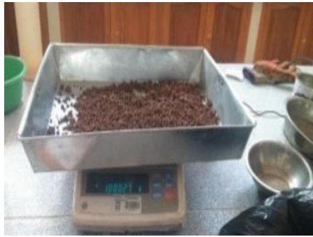
Figura 2.2. Pesado del suelo húmedo con método de campo
