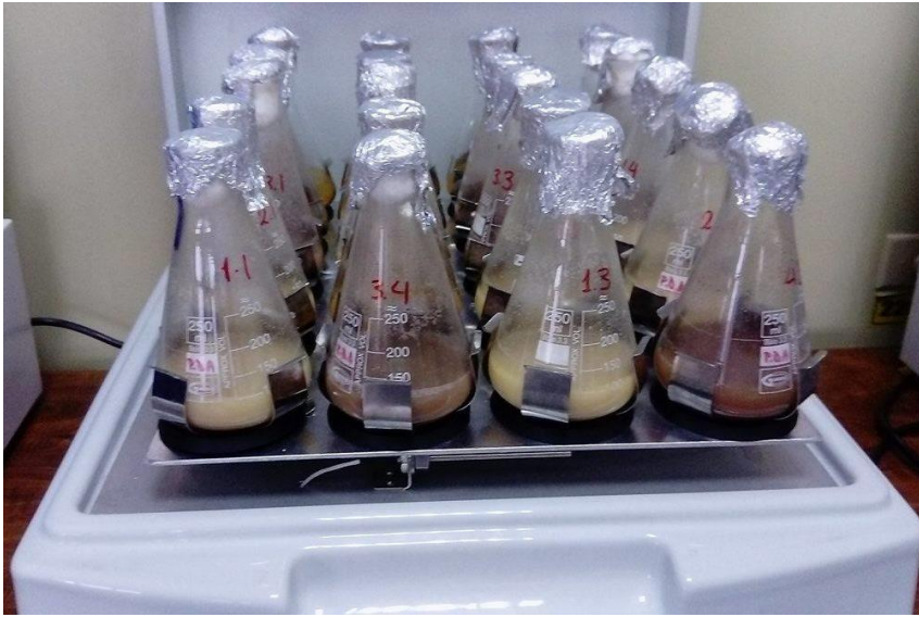
Figura 12. Fermentación en incubadora a 35 °C y 100 rpm Elaborado por: las autoras, 2018.
