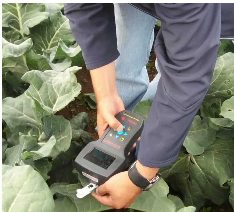
Figura 19. Determinación de la eficiencia cuántica del fotosistema II Elaborado por: las autoras, 2018.
