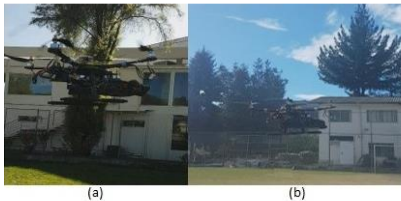
Figura 4.5: Sistema híbrido durante el despegue (a) y vuelo (b) prueba 2
