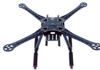
Figura 2.1: Cuadricóptero con estructura de fibra de carbono
