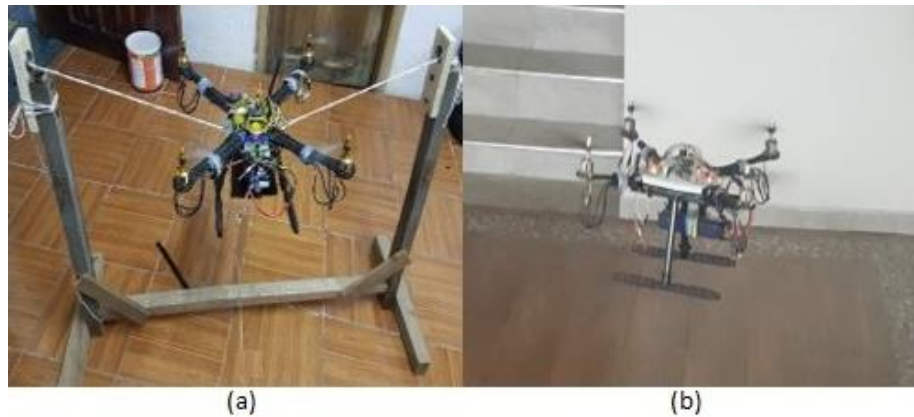
Figura 4.1: Cuadricóptero en el banco de pruebas (a) y en entorno cerrado (b)
