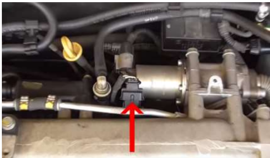
Figura 13: Ubicación del sensor MAP.
