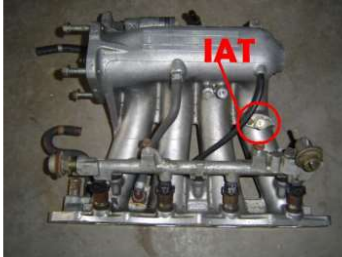
Figura 11: Ubicación del sensor IAT.
