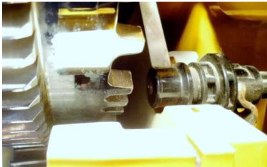
Figura 5: Sensor CKP y rueda dentada.
