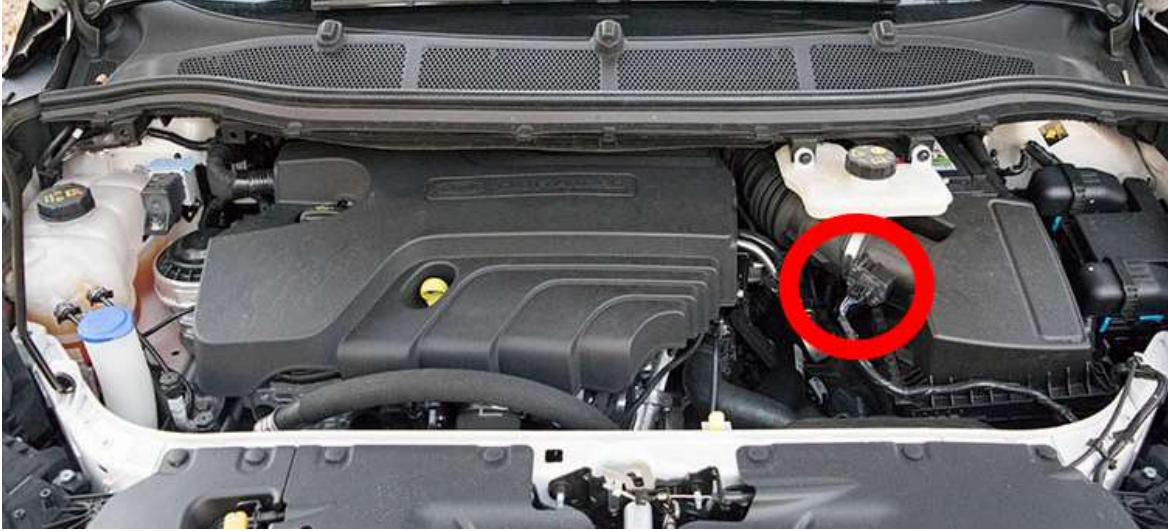
Figura 15: Ubicación del sensor MAF.
