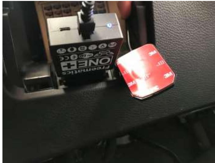
Figura A- 1: Dispositivo Freematics One + conectado.
