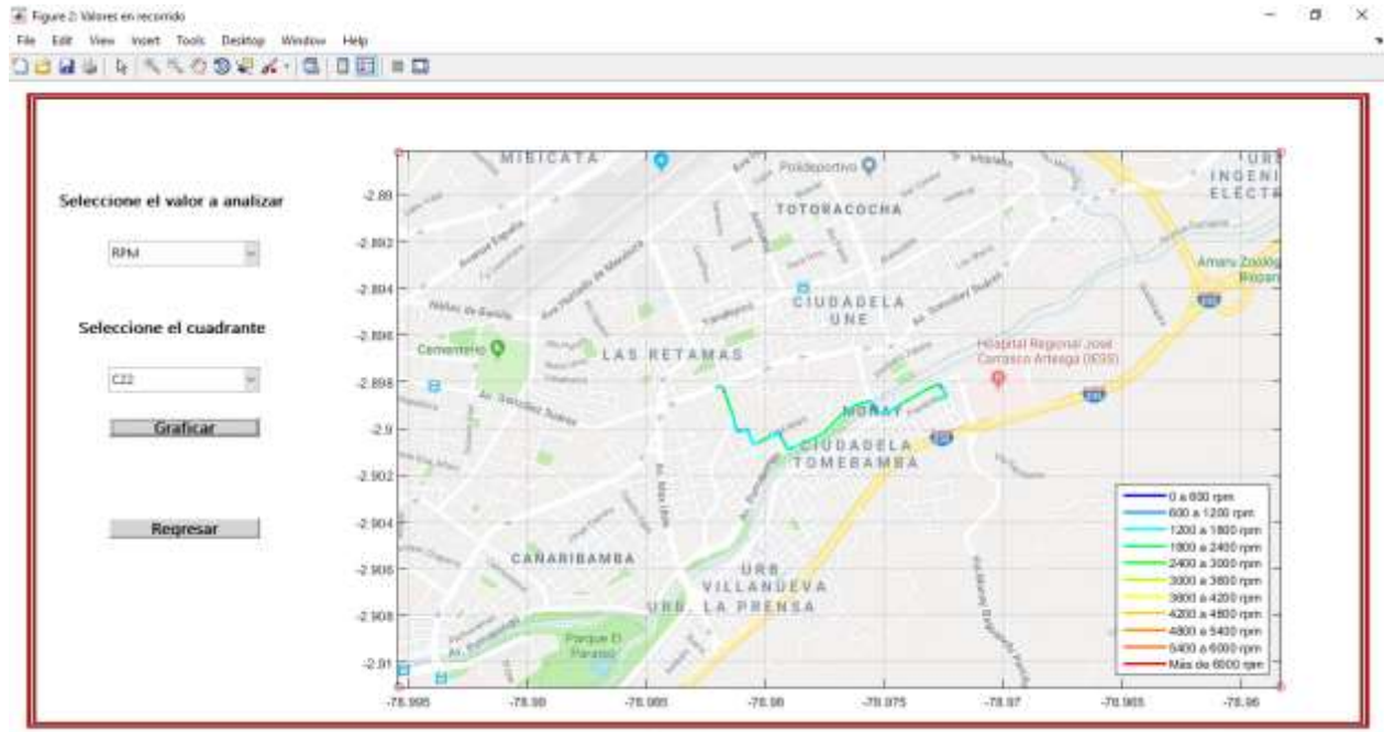
Figura A- 7: Valores en recorrido de las revoluciones del motor.
