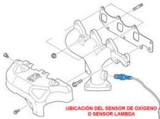
Figura 18: Ubicación del sensor de oxígeno.
